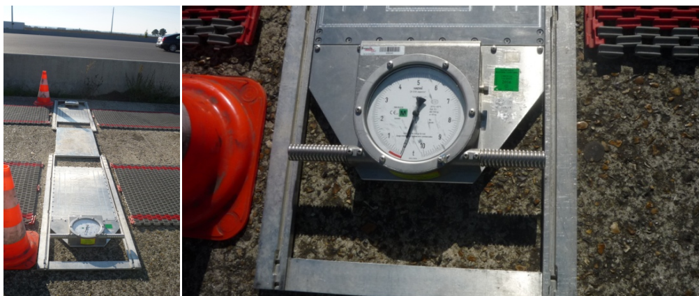
Figure 6 : Pesons Haenni, homologués par la métrologie légale, utilisés comme référence.
