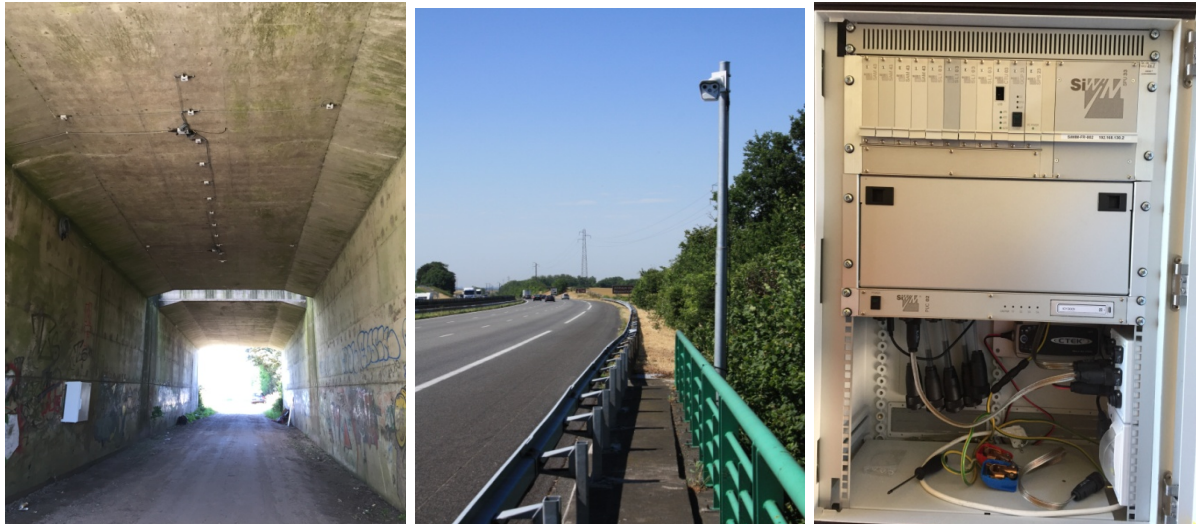
Figure 4: Capteurs installés sous la dalle d'un pont cadre, caméra photographiant les véhicules détectés, et unité centrale d'acquisition et de calcul des poids et dimensions des véhicules.
